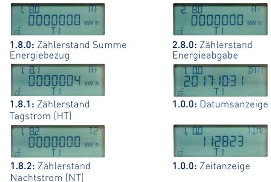
Standardmäßig erfasst Ihr intelligenter Stromzähler Ihre Verbrauchswerte im Viertelstundentakt. Diese werden für 60 Tage direkt im Gerät gespeichert. Einmal am Tag sendet der Stromzähler den täglichen Verbrauchswert entweder über das Stromkabel (Powerline) oder via Mobilfunk (LTE) an den Netzbetreiber.
